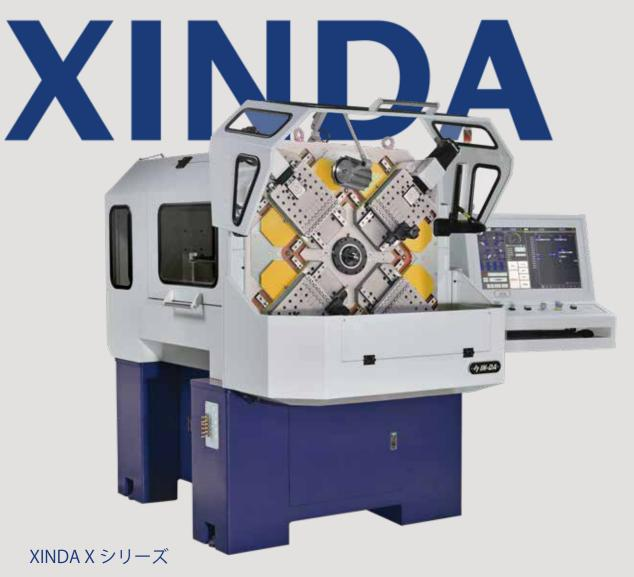
X型に配置された4つの複合移動プラットフォーム構成において、各ユニットが水平・垂直に移動することで幅広い加工を可能とし、ほとんどのスプリング・フォーミングアプリケーションに対応することができます。全ての加工工程はパラメーターで設定されており、新しいオペレーターでも短期間で使用方法を習得する事が可能となります。また、ツールホルダーの座標系とパラメーター設定を保存する事により、過去の生産工程の設定を素早く復元し、生産プロセスの標準化を支援することができます。
