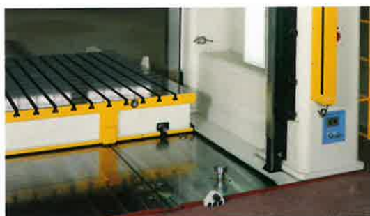
テーブルボルスタークランプ機構 Clamp device for table bolster
