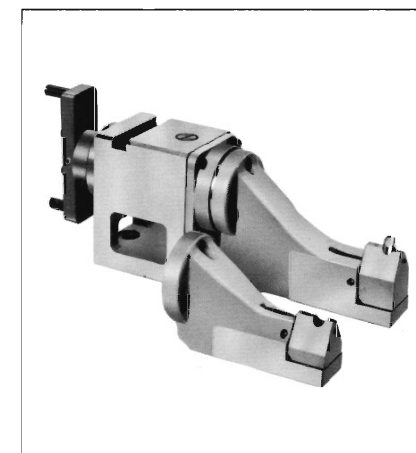
⑩ 30Rドレッシング装置(DRR-30) テーブル上に取付け、工作物の凸R部及び凹R部を研削するときのトイン成形装置です。成形しうる最大R: 凸凹共30mm
