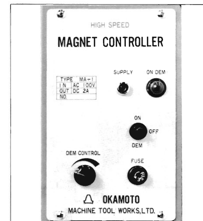
⑤ 自動式脱磁コントローラ 電磁チャック上の工作物の取外しが容易に行なえます。
