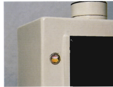
防塵対策 各案内面の防塵には十分な対策がなされています。
