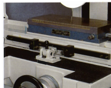
テーブルストップ パンチなどの行き止り研削で反転精度を高めることができます。
