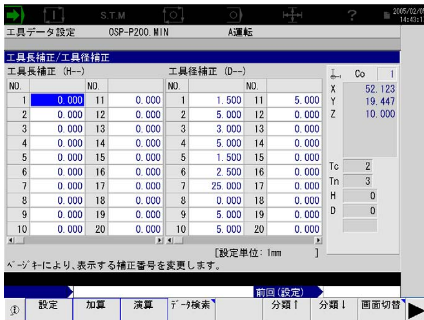
Fig.4-1 工具長補正/工具径補正画面
