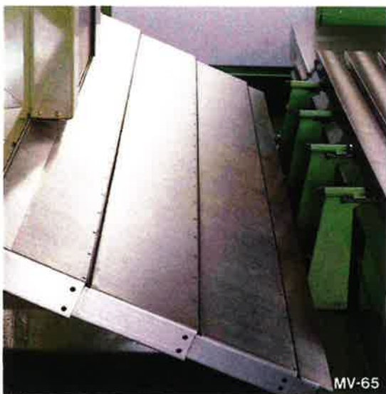
機械の両サイドには、大型のチップバケットを装備。 オプションにより、チップコンベヤも装着できます。
