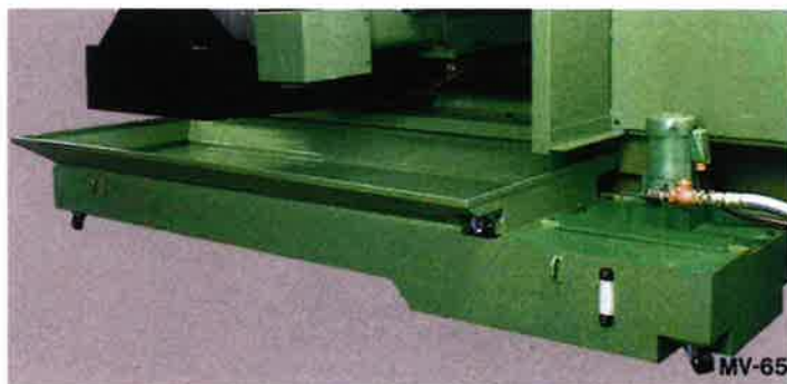
機械の両サイドには、大型のチップバケットを装備。 オプションにより、チップコンベヤも装着できます。
