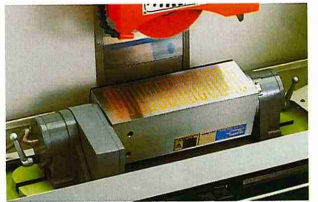
サインバー式マグネットチャック 幅×奥行(300×110) Magnetic chuck with sin bar
