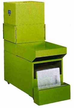
吸塵給水装置 (手動ペーパーフィルタ付) 幅×奥行×高さ(540×1300×1300) 使用モータ 40W(給水用) 0.4kW(吸塵用) ペーパーサイズ 370mm×50mm 吸塵能力 50/60Hz、9.0/10.8m 3 /min ポンプ能力 50/60Hz、19/25Q/min タンク容量 100Q Dust collector/Coolant device with manual paper filter winder
