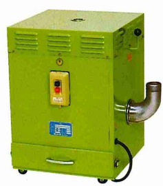
吸塵装置 幅×奥行×高さ(450×450×650) 使用モータ 0.4kW 風量 50Hz 150Q/sec、60Hz 180Q/sec 静圧 50Hz 170mmA g 、60Hz 250mmA g Dust collector
