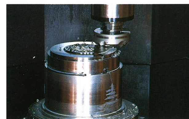
フェイスミルカッタによる端面ミーリング加工
