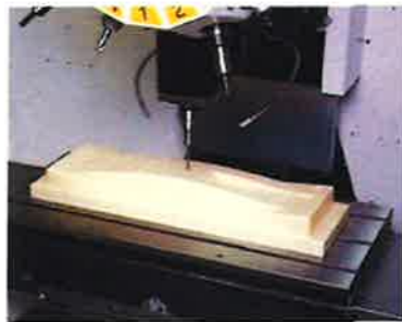
※加工プログラム提供: 富士通株式会社殿 (Unigraphicsで作成) ワーク: パソコンフロントパネル 材質: ABS樹脂
