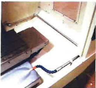
機内洗浄付きクーラント装置 (オイルガン付き)
